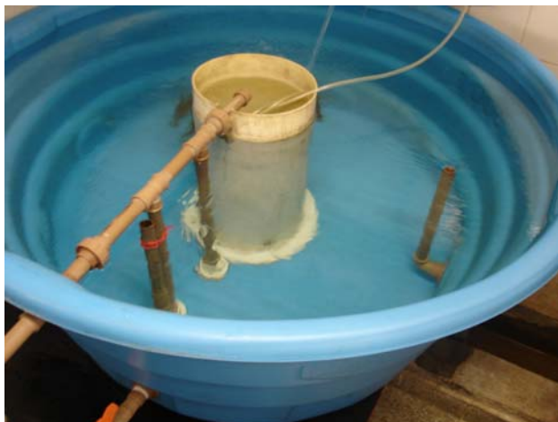
Figura 03. Tanque para manutenção dos peixes em exercício. Os canos de pvc perfurados estão acoplados à bomba d'água de forma a promover correnteza na velocidade de 20 \text{ cm.s}^{-1} .
