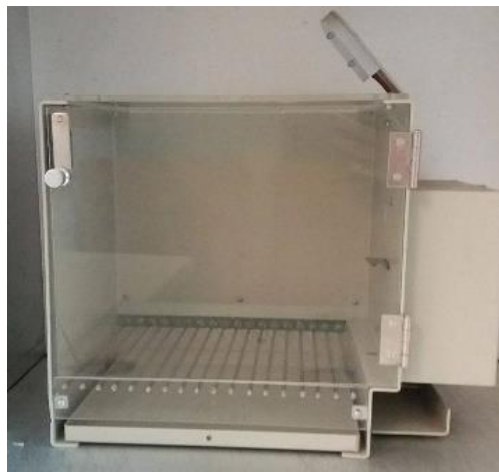
Figura 2. Fotografia da caixa experimental utilizada para o procedimento de medo condicionado à luz, nas fases de teste e reteste, para todos os grupos. Fonte: Zapparoli (2017)
