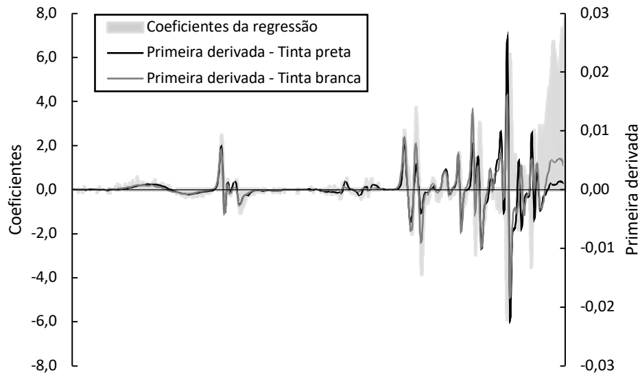
FIGURA 5.6.4 - Coeficientes de regressão do modelo proposto de 3 variáveis latentes e a primeira derivada dos espectros da tinta preta e da tinta branca para previsão de densidade.
