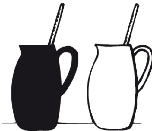
Figura A.15 – Se os recipientes são preenchidos com água quente (ou fria), o que é pintado de preto esfria (ou aquece) primeiro.
