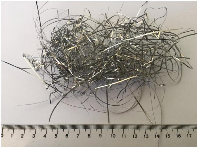
Figura 14. Fita metálica produzida por *melt-spinning*.
