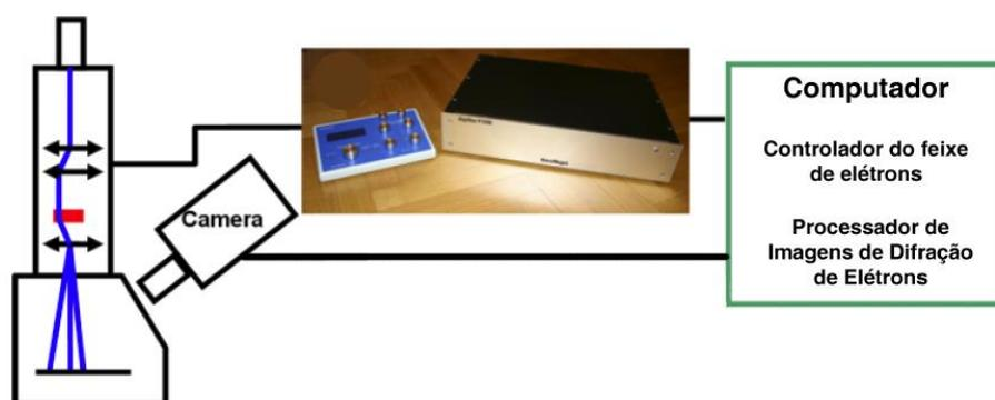
Figura 1. Esquema de funcionamento do sistema ASTAR [19].
