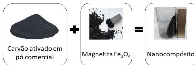
Figura 10 – Esquema empregado na síntese de carvão ativado nanomodificado. Fonte: Modificado de Jose et al., 2018.
