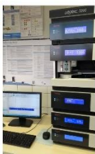
Figura 1 – Equipamento CLAE (LAB-MPBI/CCA)
