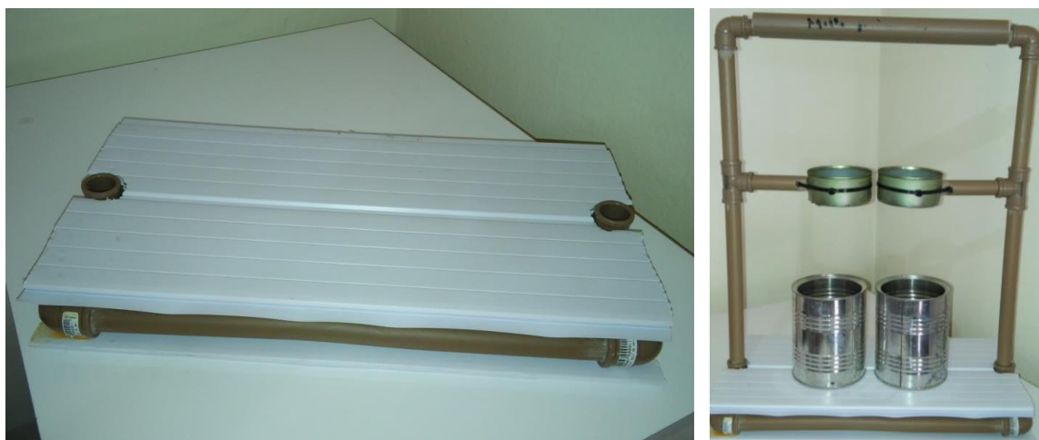
Figura A.37 – À esquerda mostramos a base da estrutura do gerador revestida com chapas de forro de PVC e à direita são mostrados os reservatórios inferiores, compostos por duas latas de leite, sobre a base revestida.
