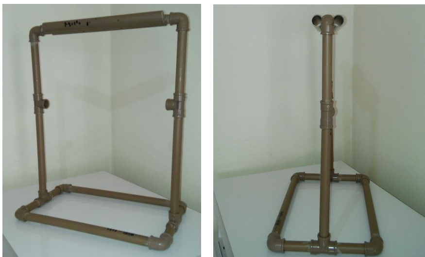
Figura A.35 – Estrutura do gerador eletrostático com a base do reservatório encaixada.
