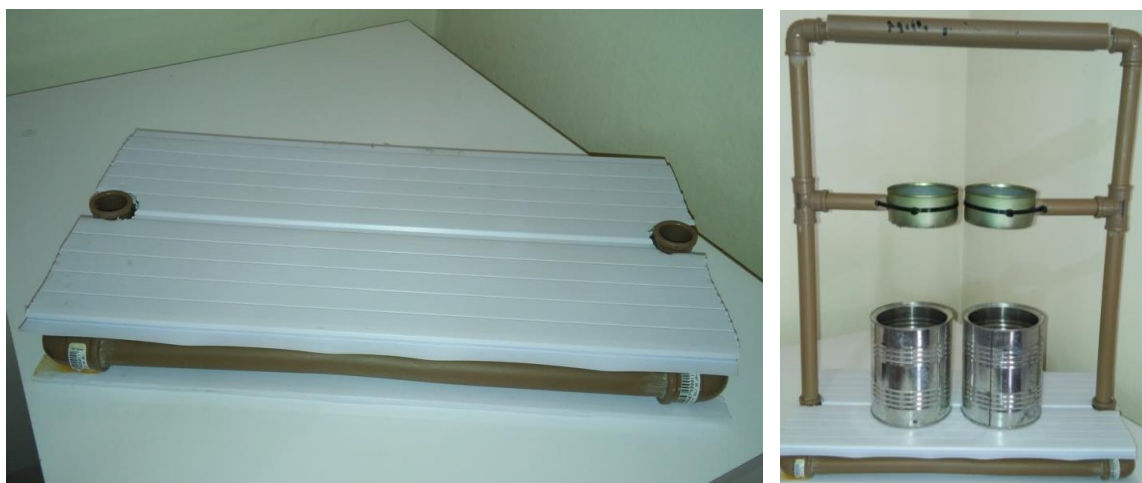
Figura 3.31 – À esquerda mostramos a base da estrutura do gerador revestida com chapas de forro de PVC e à direita são mostrados os reservatórios inferiores, compostos por duas latas de leite, sobre a base revestida.
