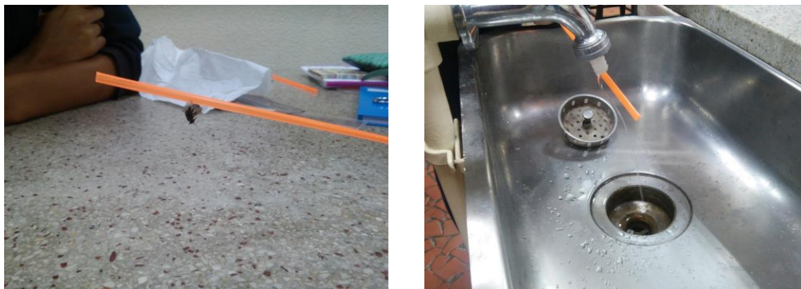
Figura A.13 – À esquerda mostramos um indutor atraindo uma pequena abelha e à direita o mesmo atraindo um filete de água.
