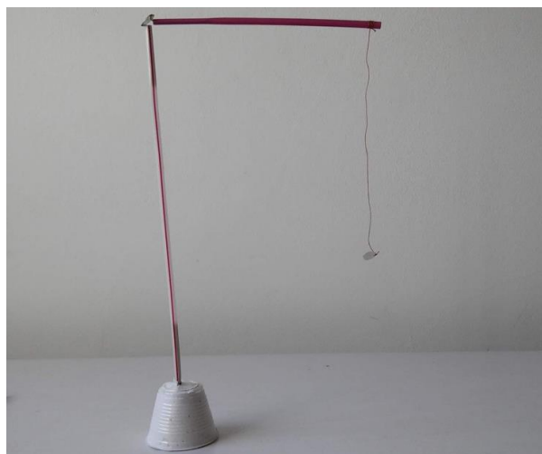
Figura 3.16 – Pêndulo elétrico composto pela base de gesso, canudos, fio de seda e pedaço de papel em forma circular.
