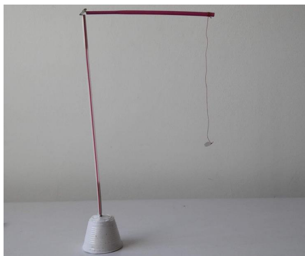
Figura A.16 – Pêndulo elétrico composto pela base de gesso, canudos, fio de seda e pedaço de papel em forma circular.
