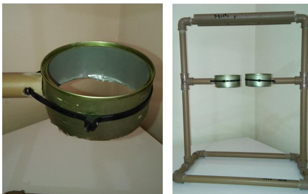
Figura 3.30 – À esquerda mostramos um dos indutores do gerador de Kelvin feito com lata de atum, sem tampa e sem fundo, preso ao cano de PVC de 7,5 cm por uma abraçadeira de nylon. À direita apresentamos os dois indutores fixos na estrutura do gerador.
