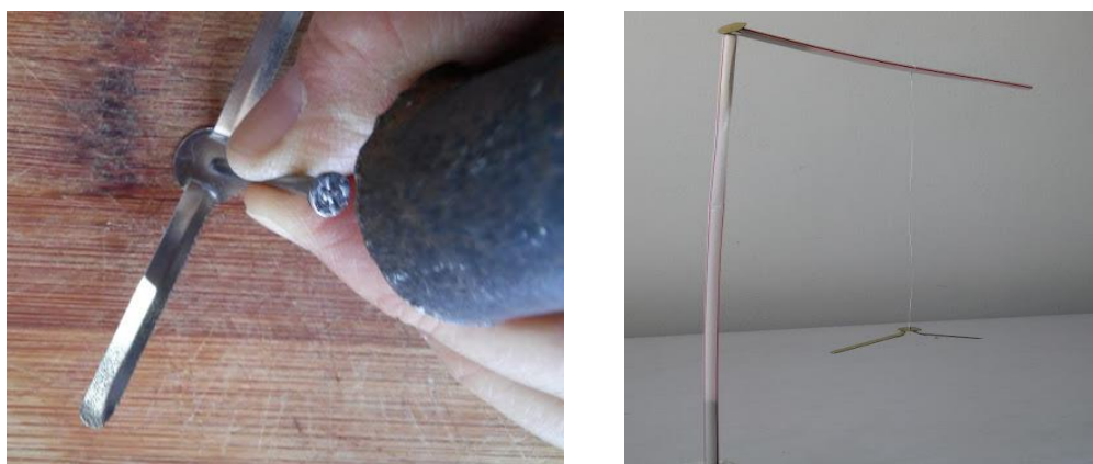
Figura 3.18 – À esquerda mostramos como fazer o furo no centro do grampo com martelo e prego e à direita o perpendicular de Fracastoro pronto para ser usado.
