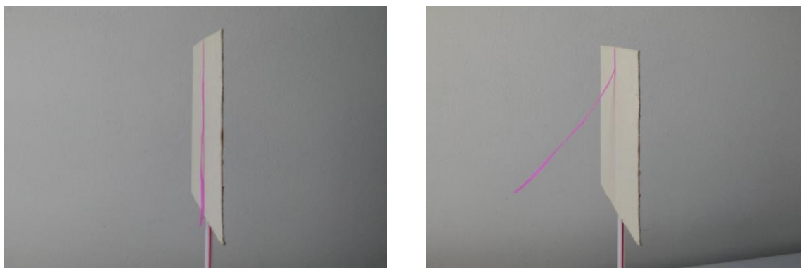
Figura 3.24 – À direita mostramos a vista lateral do eletroscópio e à esquerda o eletroscópio carregado por contato utilizando um indutor.
