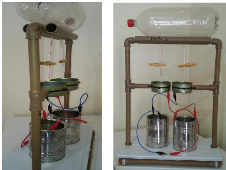
Figura A.40 – Vista lateral e frontal do Gerador eletrostático de Kelvin pronto para ser colocado em funcionamento.
