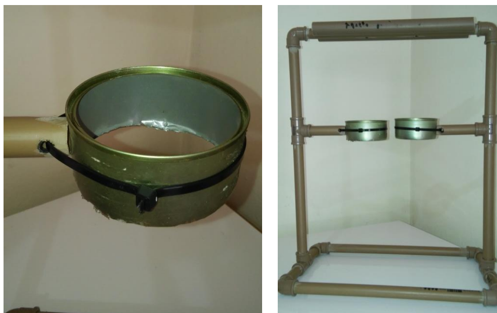
Figura A.36 – À esquerda mostramos um dos indutores do gerador de Kelvin feito com lata de atum, sem tampa e sem fundo, preso ao cano de PVC de 7,5 cm por uma abraçadeira de nylon. À direita apresentamos os dois indutores fixos na estrutura do gerador.
