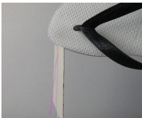
Figura 3.25 – Eletroscópio sendo descarregado por um chinelo de borracha.
