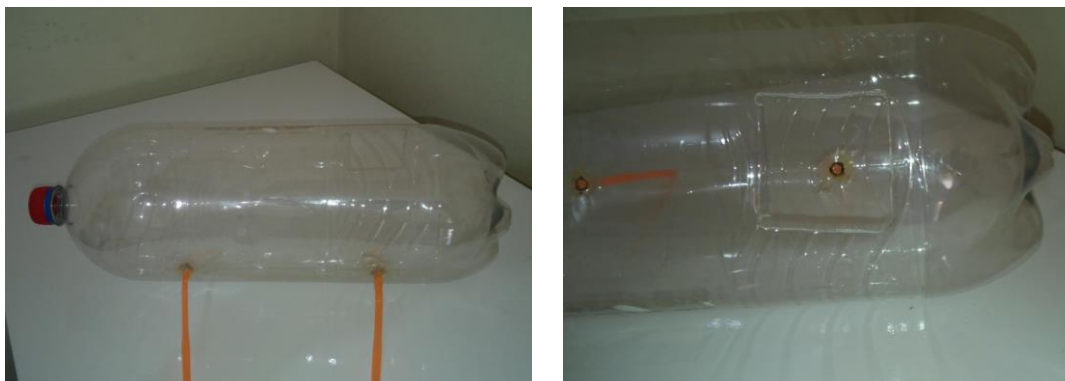
Figura A.39 – Reservatório superior, composto por uma garrafa PET, mostrando os canudos presos por cola quente em dois furos feitos na garrafa para direcionar o escoamento de água através dos indutores. À esquerda mostramos um corte de dimensões de 2 cm por 2 cm para realizar o abastecimento do reservatório quando o gerador estiver em funcionamento.
