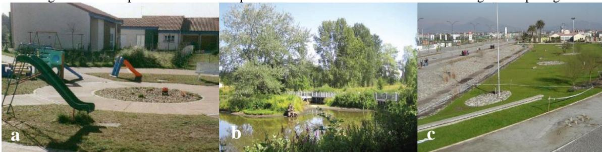
Figura a) poço de infiltração integrado à playground. Fonte: Batista et. al (2005). b) bacia de retenção na forma de uma lagoa. Fonte: Cormier e Pellegrino (2008). c) reservatório de retenção e uso de lazer em Santiago do Chile. Fonte: <http://aquafluxus.com.br>.
