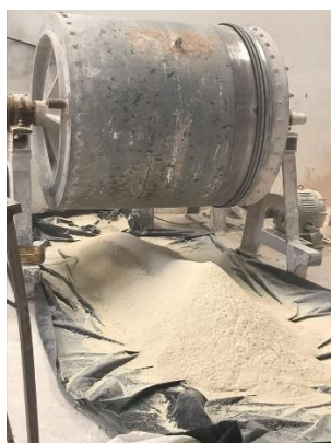
Figura 3.5 - Moinho descarregando o pó de vidro
