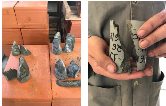
Figura 3.17 Modos de ruptura à compressão axial.
