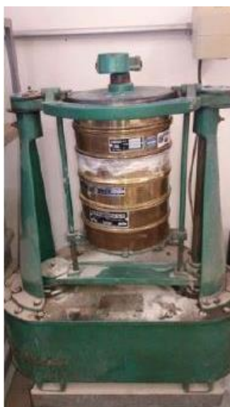
Figura 3.6 - Peneirador mecânico utilizado no peneiramento do pó de vidro.
