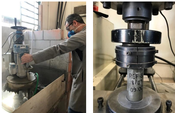
Figura 3.16 a) Retífica dos corpos de prova. b) Corpo de prova sendo ensaiado à compressão axial.
