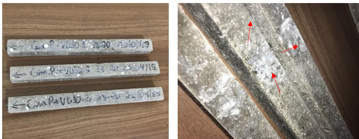
Figura 4.19 – Barras de argamassa de Cimento Padrão + VD10.
