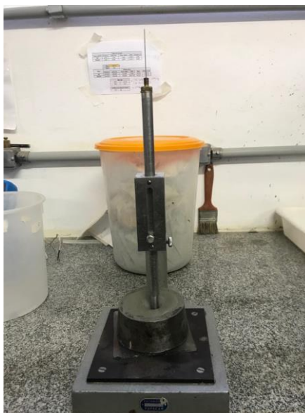
Figura 3.8 - Determinação do índice de consistência da pasta referência.
