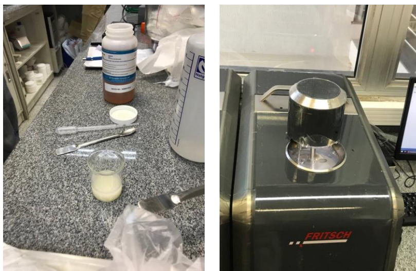
Figura 3.3 a) Preparação da amostra para o ensaio de granulometria. 3.3 b) Aparelhagem para a realização do ensaio de granulometria.
