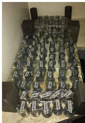
Figura 3.13 - Corpos de prova em câmara úmida.
