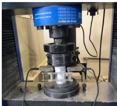
Figura 3.19 - Ensaio de Módulo de Elasticidade Estático.
