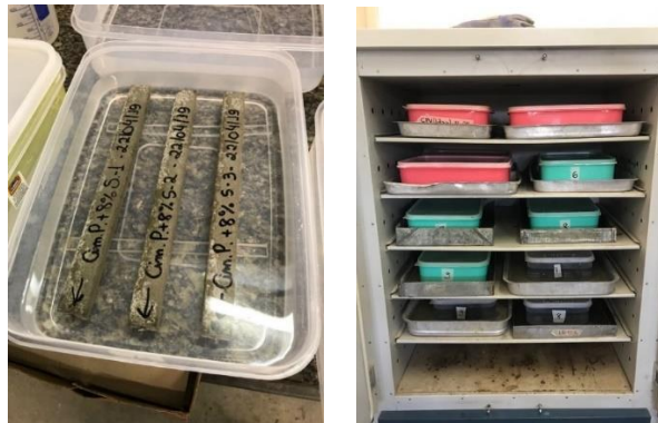
Figura 3.20 a) Barras de argamassa em recipiente; b) Recipientes em estufa ventilada.
