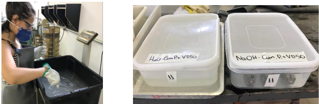
Figura 3.21 a) Preparo da solução de NaOH; b) Recipientes com água e com NaOH.
