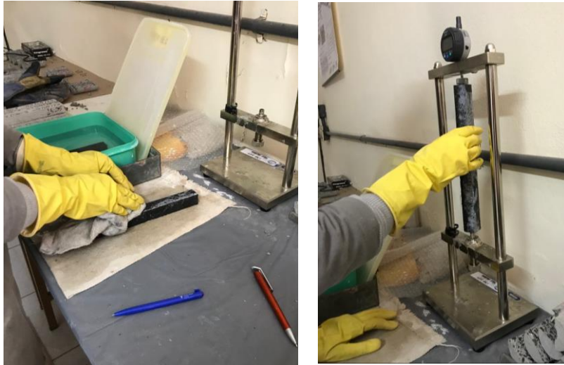
Figura 3.22 a) – Retirada do excesso de solução; b) Leitura da barra.
