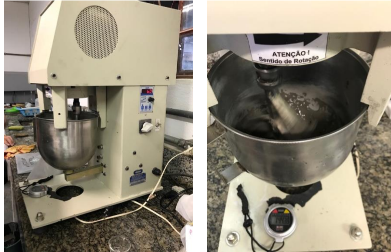
Figura 3.12 a) Argamassadeira utilizada no procedimento de mistura dos materiais. b) Argamassadeira durante ensaio.
