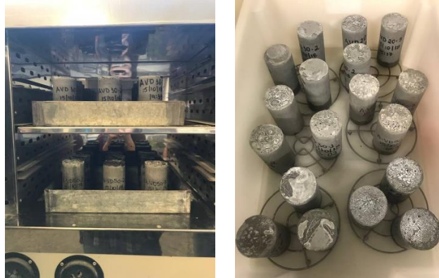
Figura 3.15 a) Corpos de prova em estufa até constância de massa. b) Corpos de prova em recipientes com água no ensaio de absorção de água por capilaridade.
