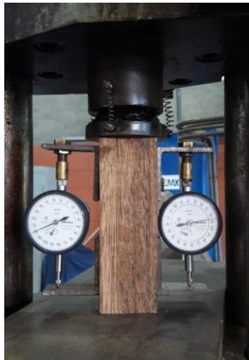
A  $f_{c0}$  foi expressa pela razão entre a força máxima de compressão ( $F_{c0,máx}$ ), aplicada no decorrer do ensaio, e a área da seção transversal do corpo de prova ( $A$ ), conforme apresenta à Equação 3.3.
