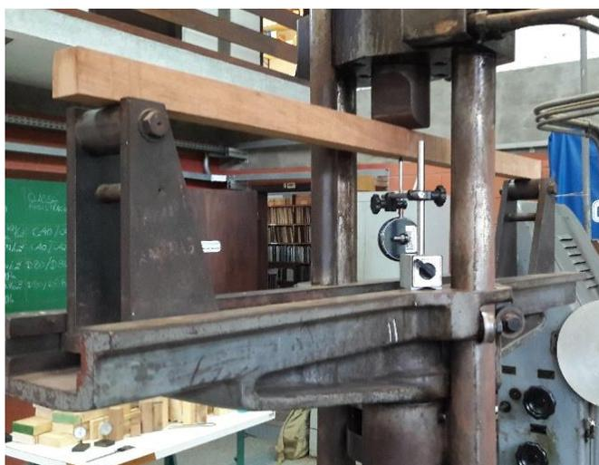
Atendendo as prescrições da ABNT NBR 7190 (1997), os corpos de prova prismáticos foram confeccionados com exatidão dimensional de 0,1 mm, seção transversal quadrada de 5 cm de lado e comprimento (na direção paralela às fibras) de 115 cm, respeitando-se a relação  $L/h \geq 21$ .
