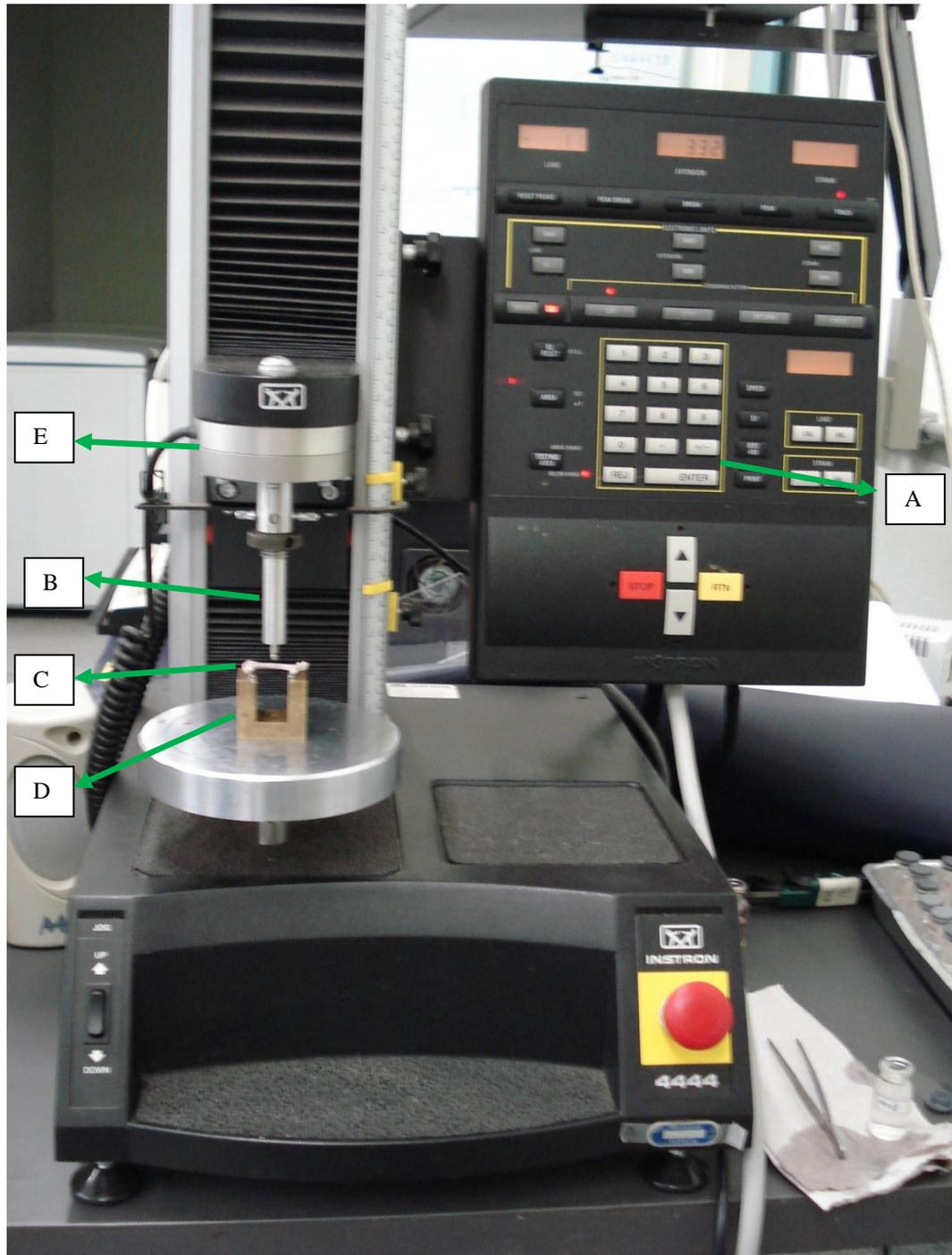
Figura 2. Foto ilustrativa da máquina de ensaio universal Instron (modelo 4444) preparada para o teste de flexão a três pontos em fêmur de rata. A: painel de controle; B: haste cilíndrica para a aplicação de carga (força); C: osso; D: suporte; E: célula de carga ligada à ponte de extensimetria.
