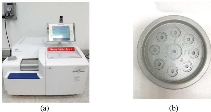
Figura 22 - Fotografias: (a) equipamento de TG; (b) porta amostras.
