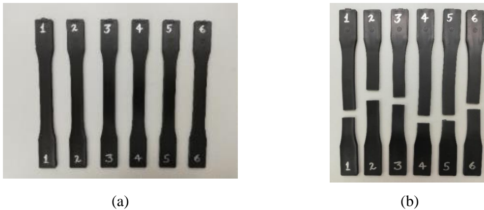
Figura 29 - Corpos de provas de matriz AM/RT fixa (a) antes e (b) após os ensaios de tração
