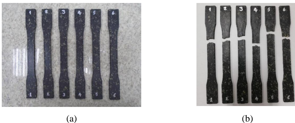
Figura 28 - Corpos de provas de matriz PE/PP fixa (a) antes e (b) após os ensaios de tração
