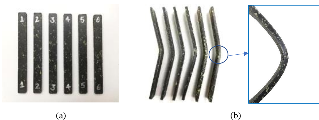
Figura 26 - Corpos de provas de matriz AM/RT fixa (a) antes e (b) após ensaios de flexão
