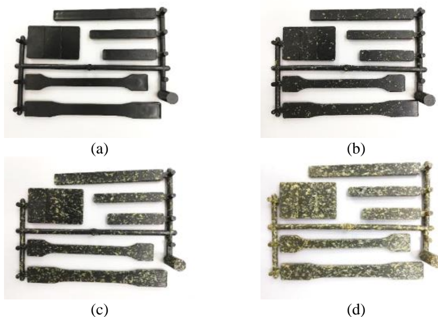
Figura 12 - Corpos de provas injetados com a proporção AM/RT fixa: (a) B10RT-6AM/0-100, (b) C10RT-6AM/25-75, (c) C10RT-6AM/75-25 e (d) B10RT-6AM/100-0
