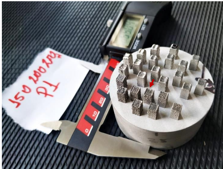
Figura 4.29- Comportamento da, a) porosidade em função da potência e velocidade de varredura do laser e b) porosidade em função da energia de entrada e c) Amostras produzidas com diferentes conjuntos de parâmetros, com a amostra de menor porosidade em destaque.
