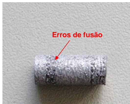
Figura 4.7- a) Densidade de Arquimedes em função da energia de entrada para diferentes conjuntos de parâmetros; b) amostras com trincas laterais; c) amostras com erros de fusão.
