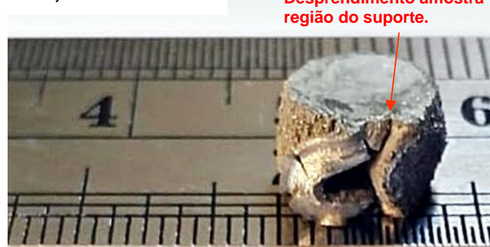
Figura 4.19- Imagens das amostras após ensaio de compressão sob: a) temperatura ambiente (RT) e b) 400°C.
