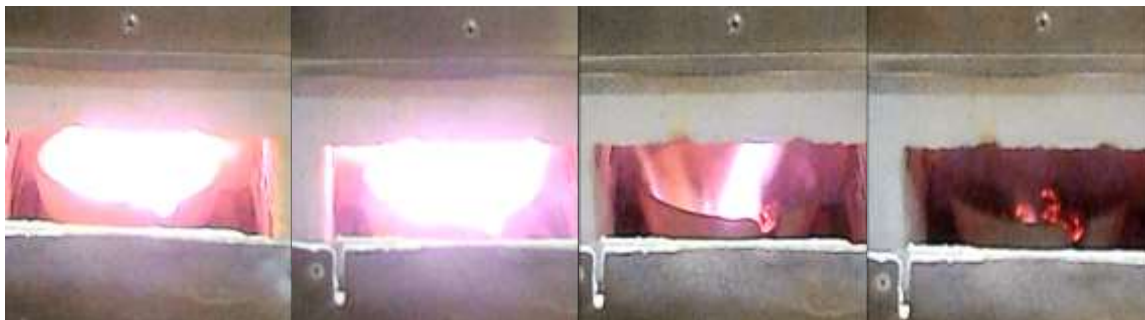
Figura 4.1: Evolução da intensidade da chama para a reação de combustão da amostra SCS-0.5-ureia.
