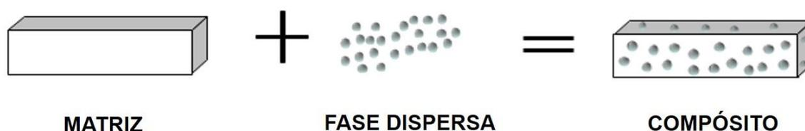
**Figura 4** - Ilustração da estrutura básica de um compósito e suas fases separadas.
