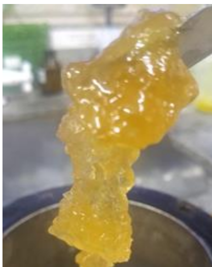
Figura 30: Celulose funcionalizada, razão molar 1:3, logo após ser retirada do reator.
