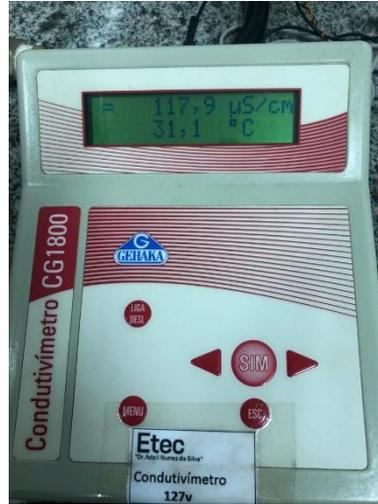
**FIGURA 6.5- Condutímetro utilizado no experimento**
