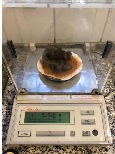
**FIGURA 8.5- Pesagem palha de aço após cinco dias**
