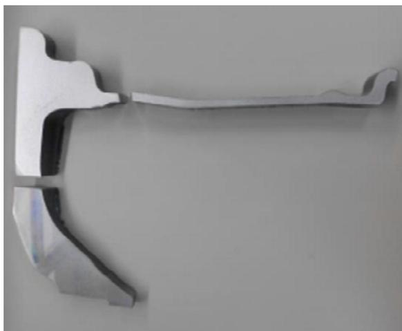
Figura 3.6 – Perfil de roda preparado para ensaio de dureza [11].
