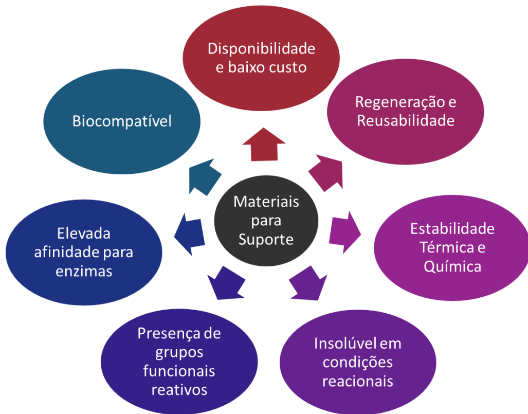
FIGURA 1. 4: Principais características dos materiais de suporte utilizados para imobilização enzimática. Fonte: Adaptado de Zdarta et al. (2018) 68 .
