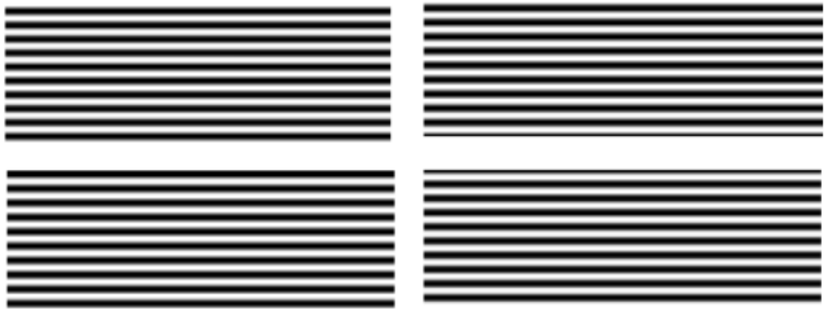
Figura 41. Grades de linhas paralelas reticulares para phase-shifting , deslocadas 90^\circ entre si.
