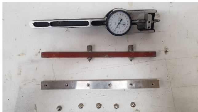
Figura 5-22 - Aparatos usados no ensaio para obtenção do comprimento de transferência
