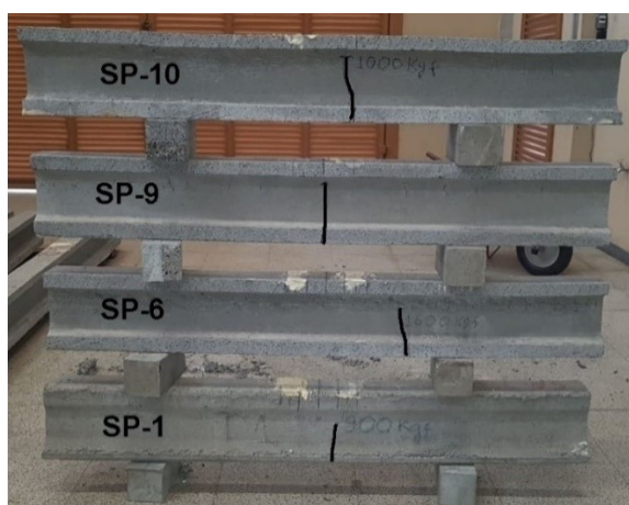
Figura 6-32 - Fissuras dos modelos série IV
