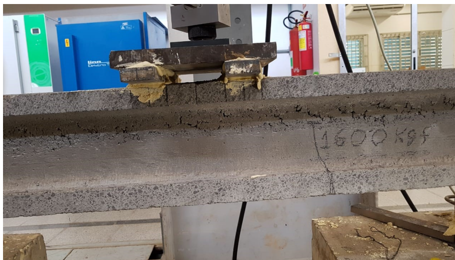
Figura 6-29 - Fissuras do modelo SP-6
