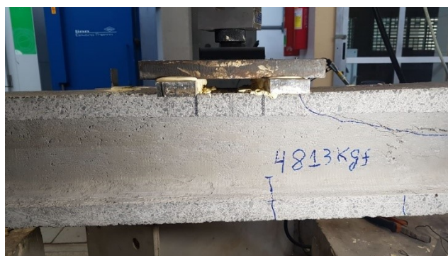
Figura 6-34 - Fissuras do modelo TR3-3
