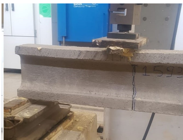
Figura 6-24 - Fissuras do modelo SP-8
