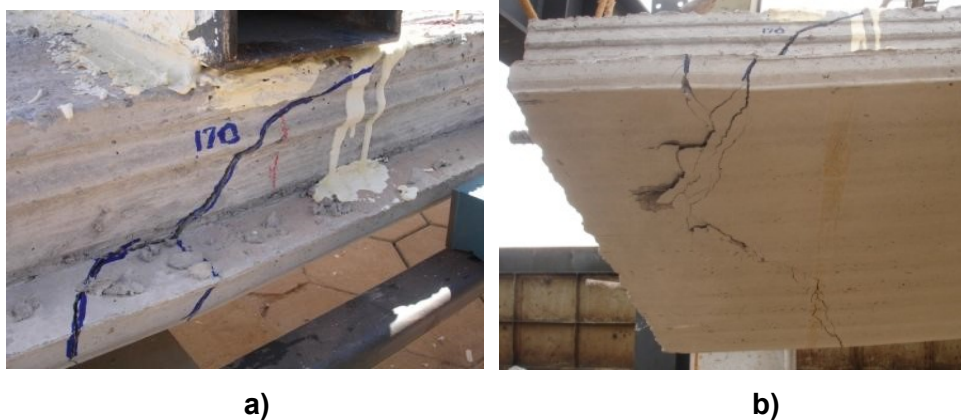
Figura 3-5 - Fissuração da laje alveolar 1A. a) Lateral esquerda, b) Lateral direita, c) Escorregamento da cordoalha.
