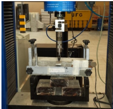
Figura 5-28 - Ensaio de flexão sob três pontos de carga com entalhe no meio do vão
