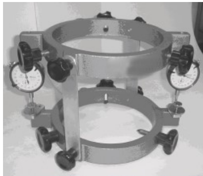
Figura 5-27 - Compressômetro com bases independentes
