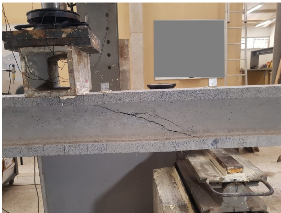
Figura 6-13 - Fissuras do modelo TR2-7
