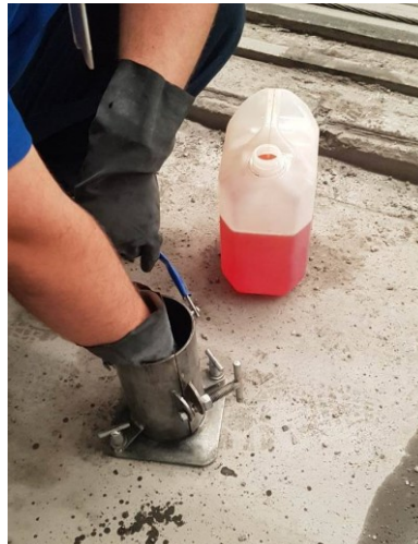
Figura 5-15 - Aplicação do desmoldante as fôrmas dos corpos de prova
