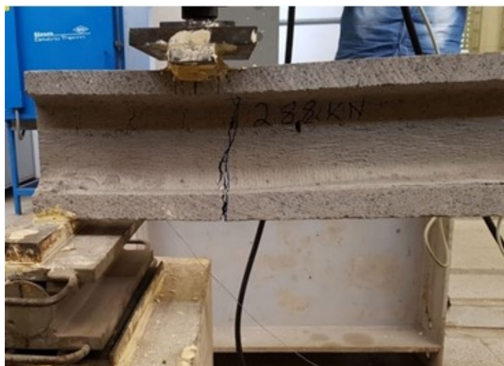
Figura 6-25 - Fissuras do modelo SP-7*
