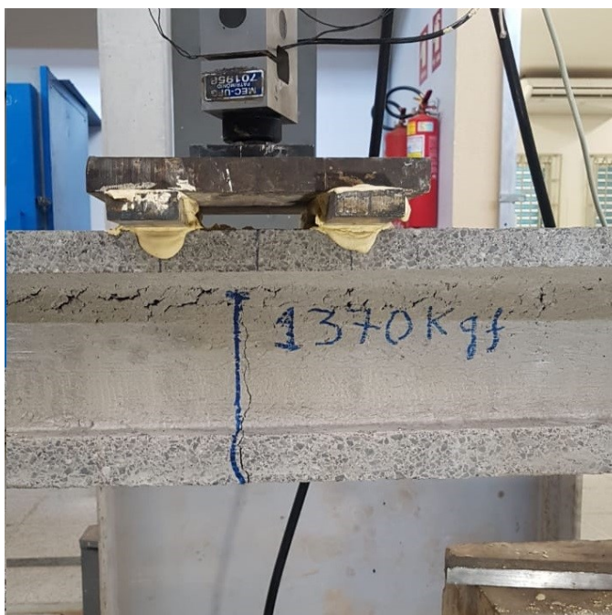
Figura 6-30 - Fissuras do modelo SP-9
