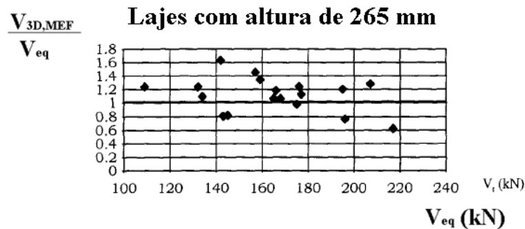
Figura 4-9 - Comparação entre equação analítica e resultado do ensaio da laje com altura de 265 mm
