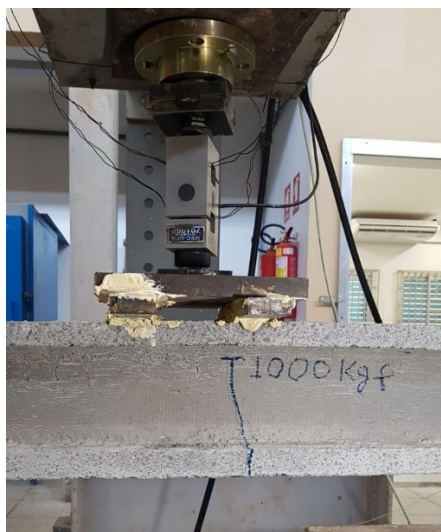
Figura 6-31 - Fissuras do modelo SP-10
