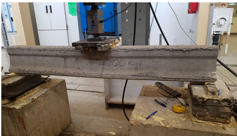
Figura 6-28 - Fissuras do modelo SP-1
