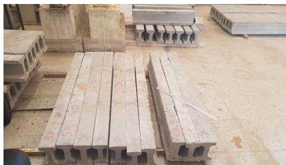
Figura 5-18 - Seguimentos cortados a partir do trecho 1 com graxa aplicada na cordoalha - Sem protensão (1,5 metros)
