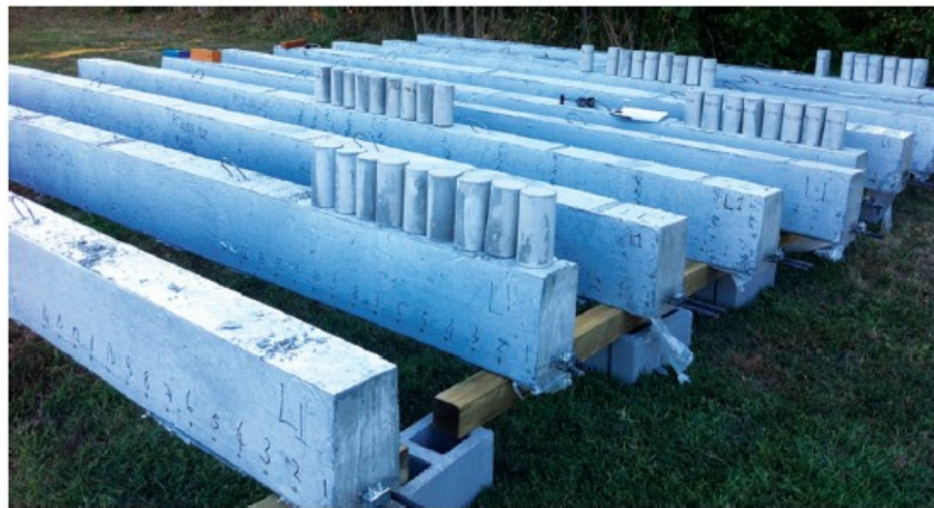
Figura 3-18 - Vigas sendo curadas para os ensaios de Ramirez-Garcia et al. (2018)
