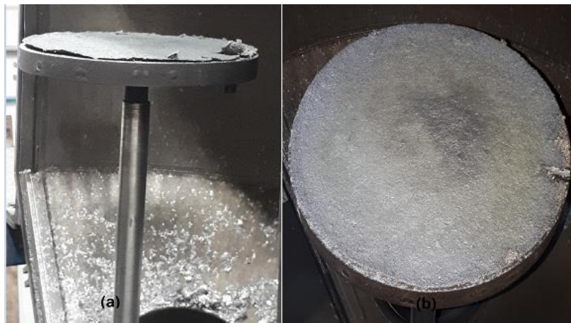
Figura 5.10 - Depósito obtido no processo de conformação por spray.
