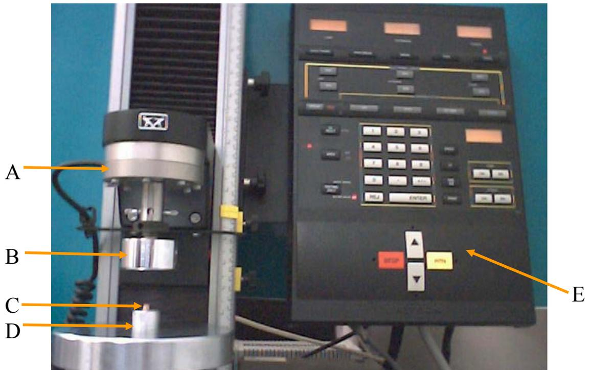
**Figura 2-** Foto da máquina de ensaio universal Instron (modelo 4444), demonstrando um teste de compressão em corpo vertebral (L<sub>5</sub>) de rato. A, célula de carga ligada à ponte de extensometria; B, cilindro de aplicação de carga; C, corpo vertebral; D, suporte; E, painel de controle.
