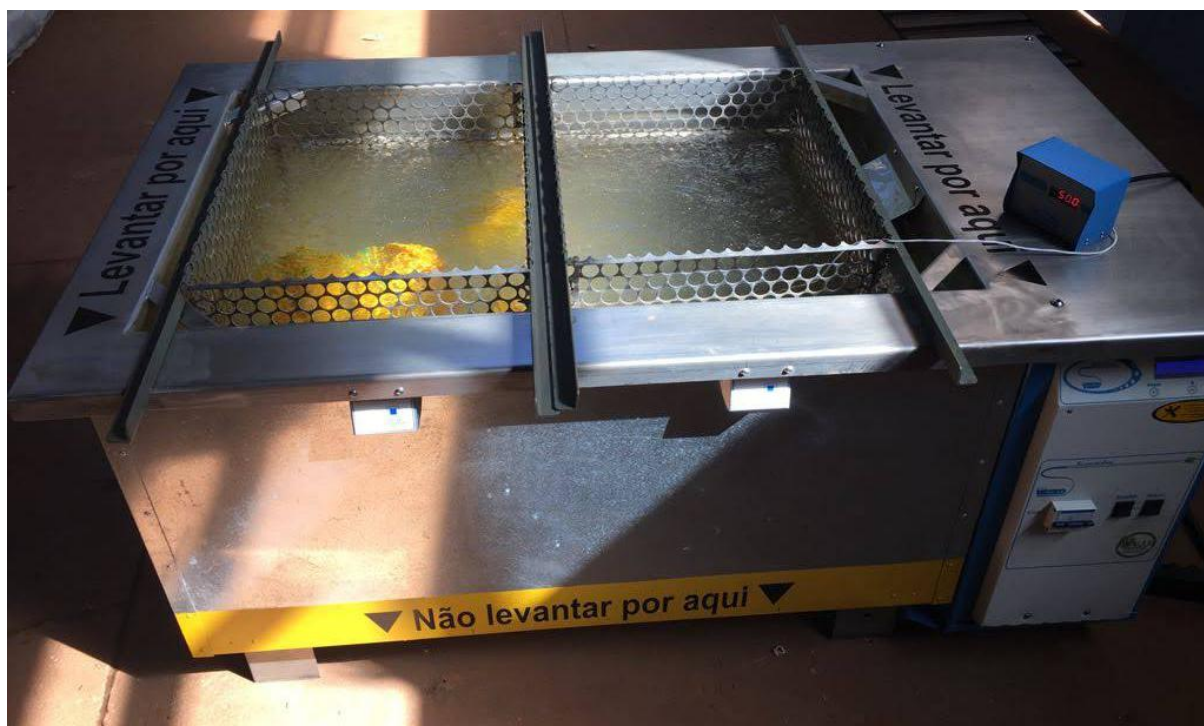
Imagem 1: processo de tratamento térmico das gemas individualizadas dentro de sacos de nylon, em tanque de 2000 litros
