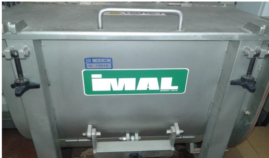
Figura 16 – Encoladeira de laboratório da marca IMAL.
