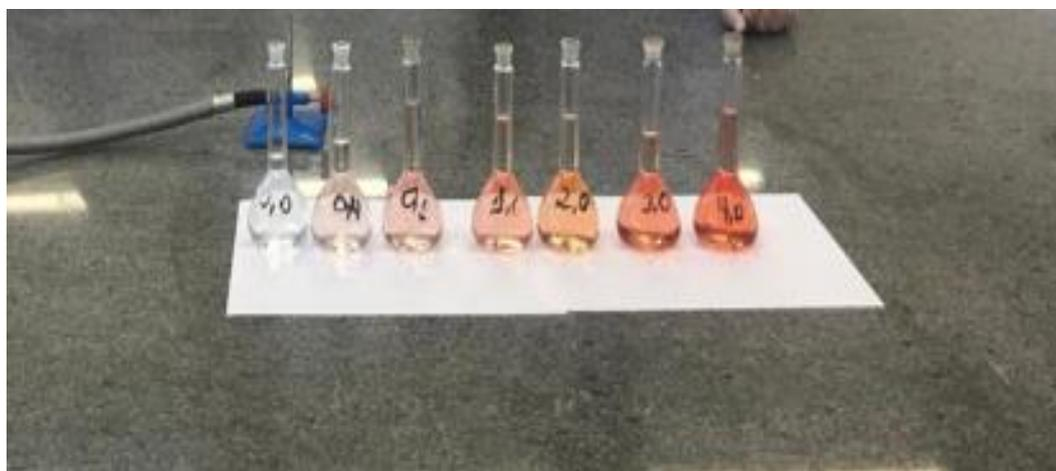
*Figura 3.10 - Soluções de concentrações conhecidas para construção de curva analítica.*
