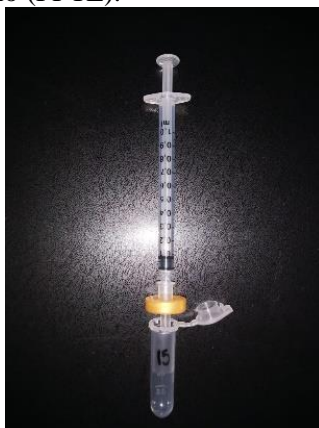
Figura 19 - Coleta das alíquotas e filtração em microfiltro (Millex – LG 0,20 \mu\text{m} / 13 mm de diâmetro) com membrana de politetrafluoretileno (PFTE).
