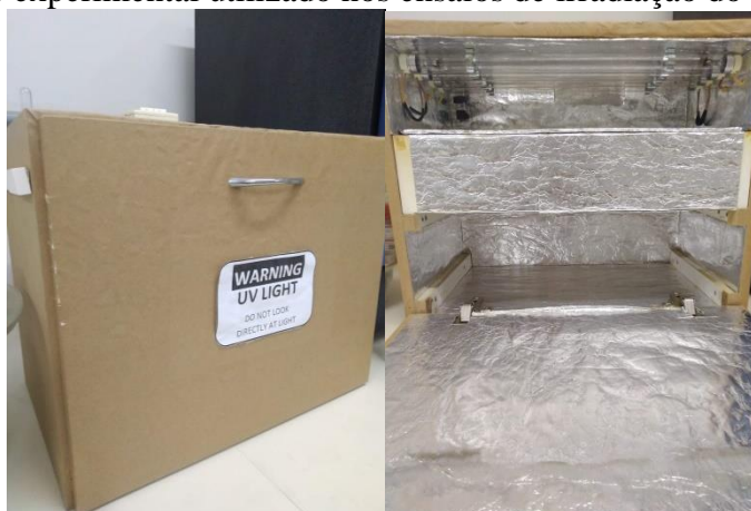
Figura 16 - Aparato experimental utilizado nos ensaios de irradiação do material com UVC.
