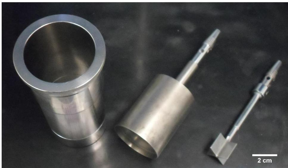
Figura 4.2 - Imagens dos acessórios utilizados nos ensaios de reologia. Da esquerda para a direita: copo, rotor cilíndrico e *vane*.
