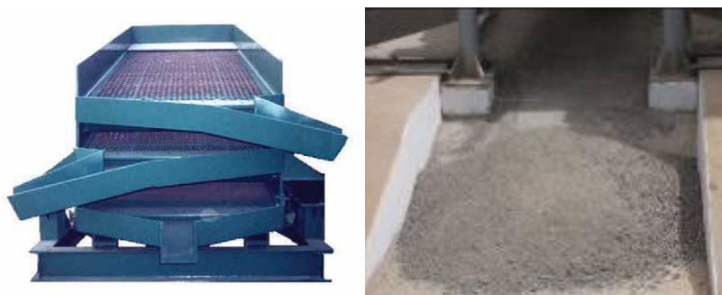
Figura 324 – (esquerda) Peneira vibratória utilizada para separar o material triturado conforme sua granulometria, com saídas em diferentes direções, para posterior alimentação das esteiras transportadoras (fonte: Martini, 2012); (direita) Agregado miúdo reciclado (Fonte: Evangelista, Costa e Zanta, 2010)
