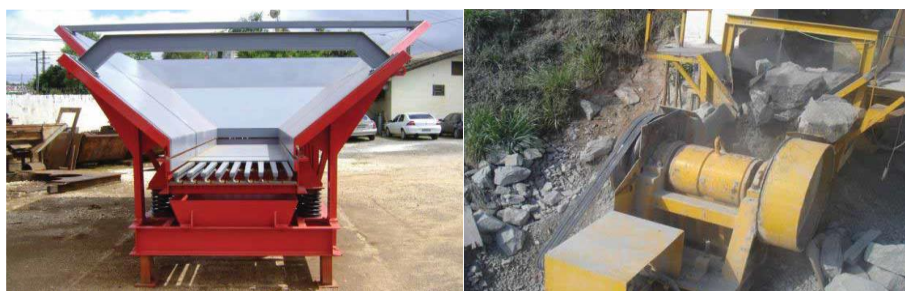
Figura 323 – (esquerda) Alimentador Vibratório utilizado no Processo de Reciclagem dos RCD; (direita) Britador de Mandíbulas utilizado para a quebra de partículas no processo da reciclagem Fonte: (Martini, 2012)
