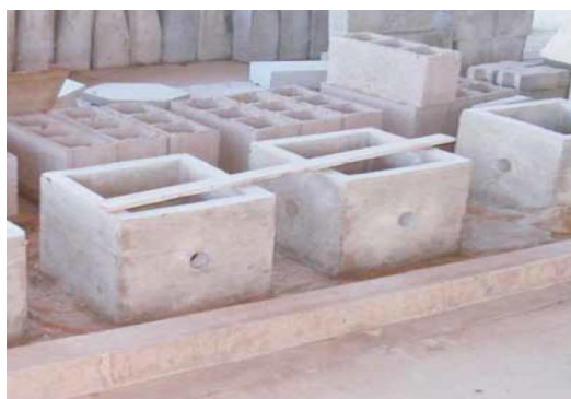
Figura 310 – Confeção de caixas de gordura com agregados reciclados (Fonte: Lima e Lima, 2012)
