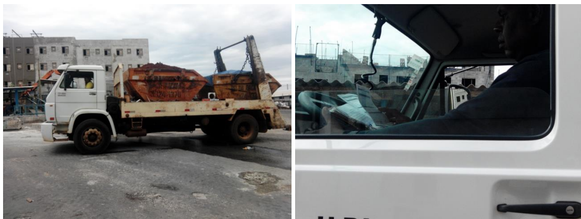
Foto 61 (esquerda) – Resíduos classe A, no caso solos, sendo retirados de canteiro por caminhão poliguindaste, fase inicial; Foto 62 (direita) – Transportador retirando do canteiro resíduos classe A, no caso solos, e em posse da respectiva ficha do tipo CTR (Fonte: o pesquisador, 2019)
