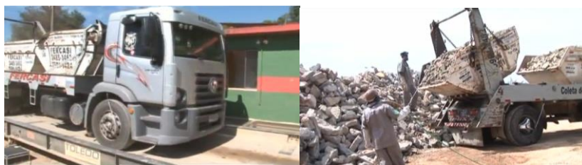
Figura 321 (esquerda) – Controle de caminhão à entrada da ATT; (direita) – Descarga de caminhão tipo poliguindaste no pátio de triagem (Fonte:
