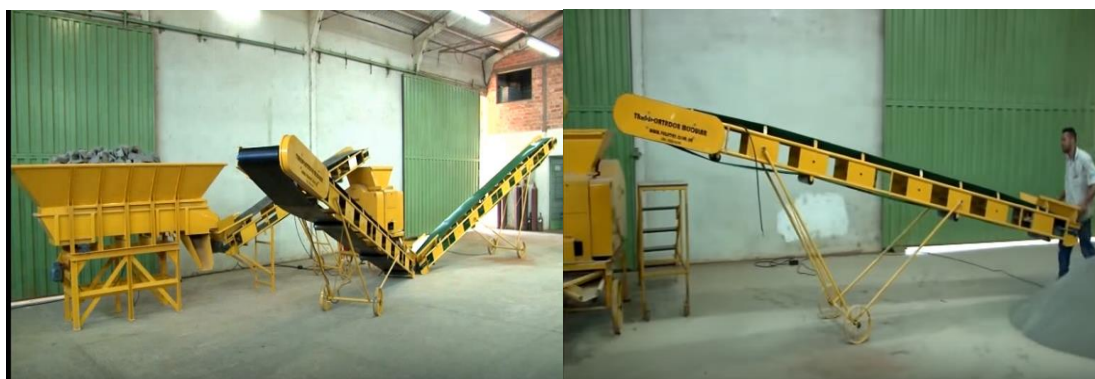
Figura 325 – (esquerda) Equipamentos de pequeno porte para “mini-usinas” de reciclagem de agregados, possíveis de instalar em canteiro; (direita) Esteira transportável por um funcionário só (Fonte: http://www.vegedry.com.br )
