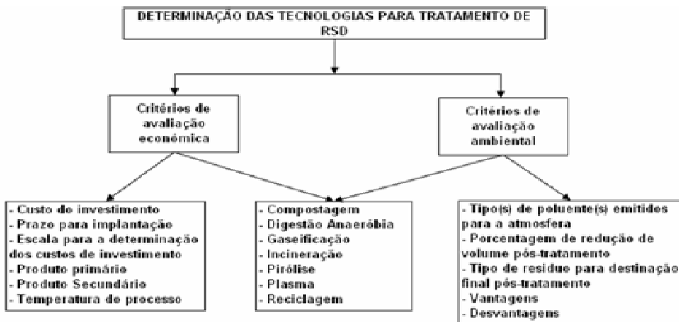
Figura 113 – Representação esquemática para a definição de critérios e tecnologias para a determinação da hierarquia entre as alternativas para tratamento de RD (Fonte: Marchezetti, A.L; Kaviski, E. e Braga, M.C.B., 2011)
