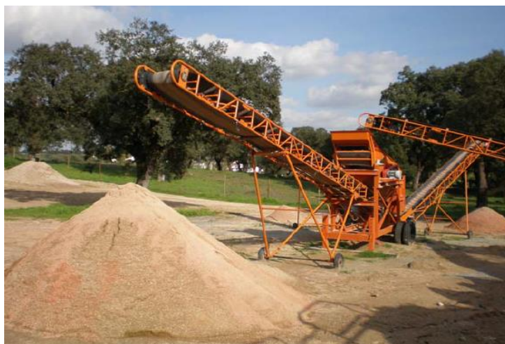
Figura 313 – Agregados reciclados após beneficiamento dos RCD/RCC (Fonte: Marques Neto, 2005)
