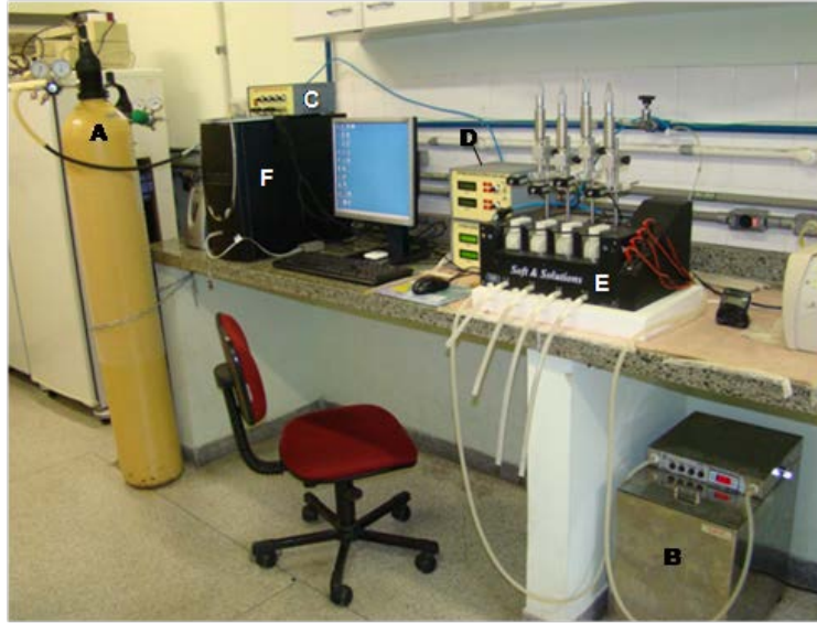
Figura 2. Set experimental utilizado para a obtenção dos registros da contração isométrica das tiras ventriculares de cascavéis: A. cilindro de mistura carbogênica; B. banho termostatizado; C. amplificador de força; D. estimuladores elétricos; E. banho com quatro cubetas; F. sistema informatizado com placa de aquisição e tratamento dos dados.
