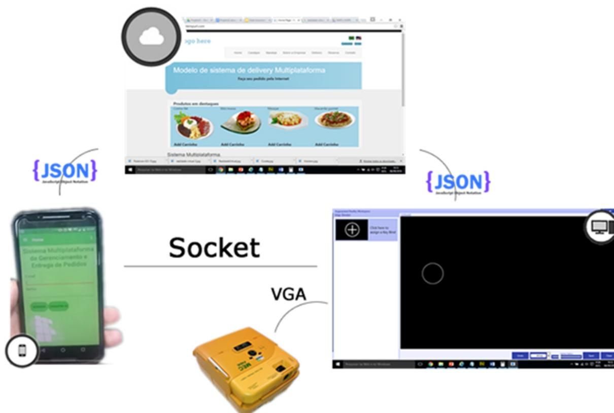
Figura 23 – Comunicação entre as versões do sistema multiplataforma.
