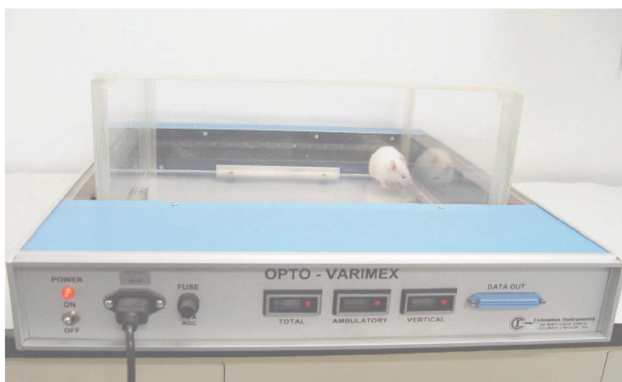
FIGURA 1 – Caixa de medida automática da atividade locomotora.
