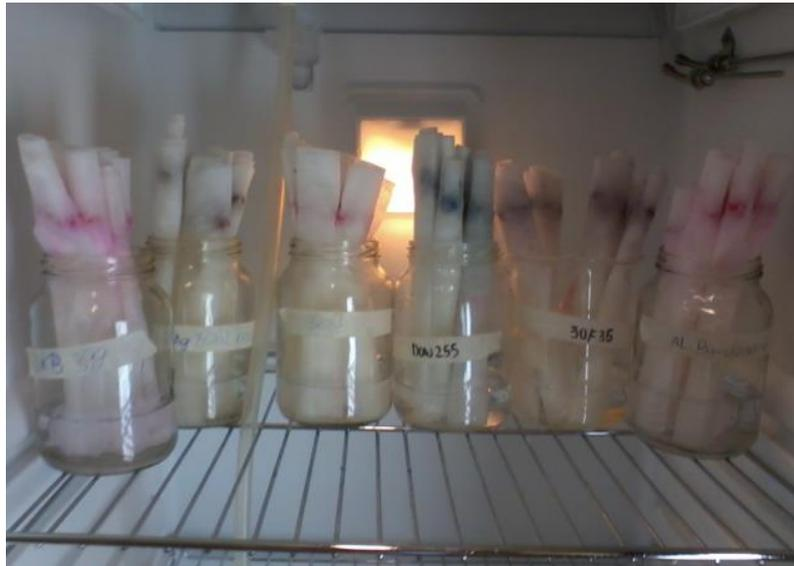
**Figura 5.** Sementes de variedades de milho envolvidas por papel germiteste, em fase de pré-germinação no interior da câmara de germinação.
