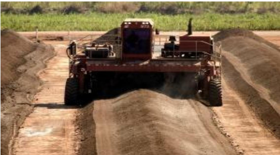
**Figura 2.** Máquina autopropelida revolvedora e enleiradora de torta de filtro.
