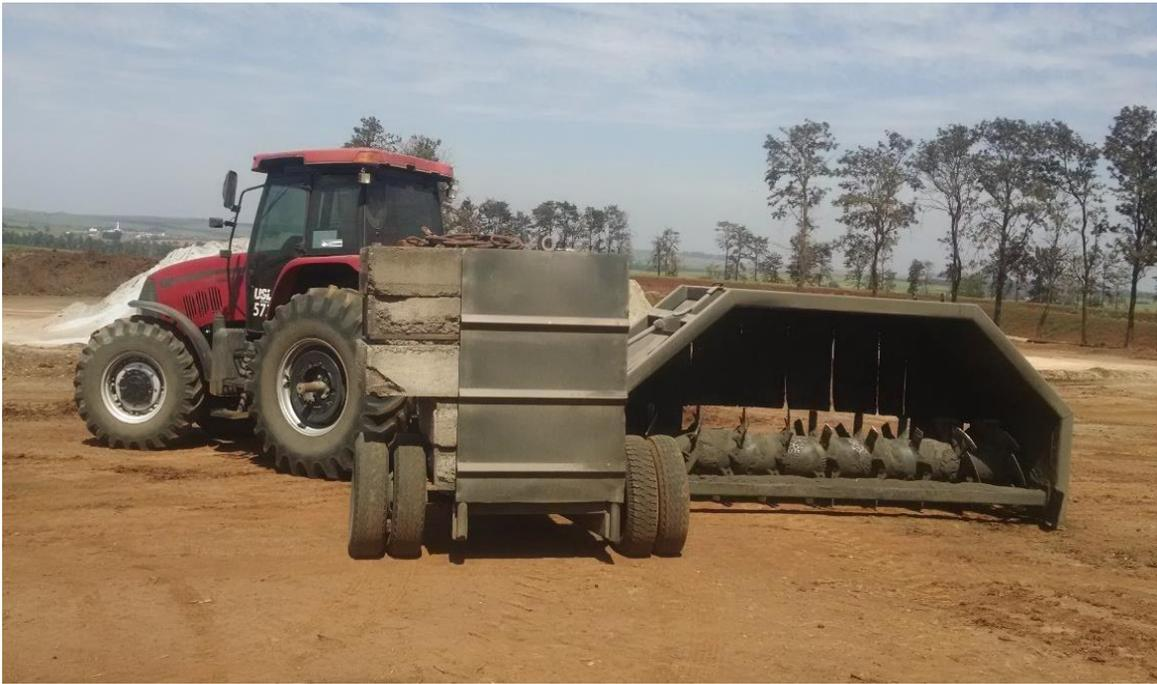
**Figura 3.** Implemento, acoplado ao trator, que atravessa as leiras de compostagem de torta de filtro por meio de um rotor. Usina Santa Lúcia, Araras/SP.
