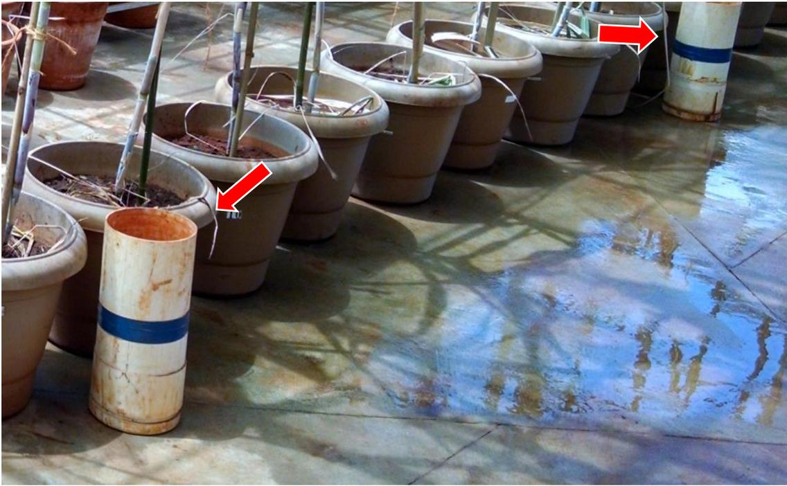
**Figura 8.** Colunas de PVC contendo solo para monitoramento da umidade.
