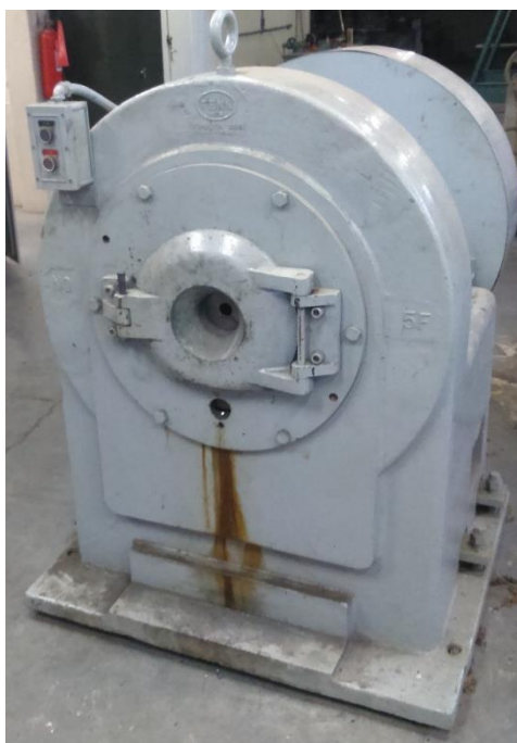
Figura 3.7 – Forja rotativa FENN modelo 5F utilizada para produzir barras com 11,9 mm de diâmetro
