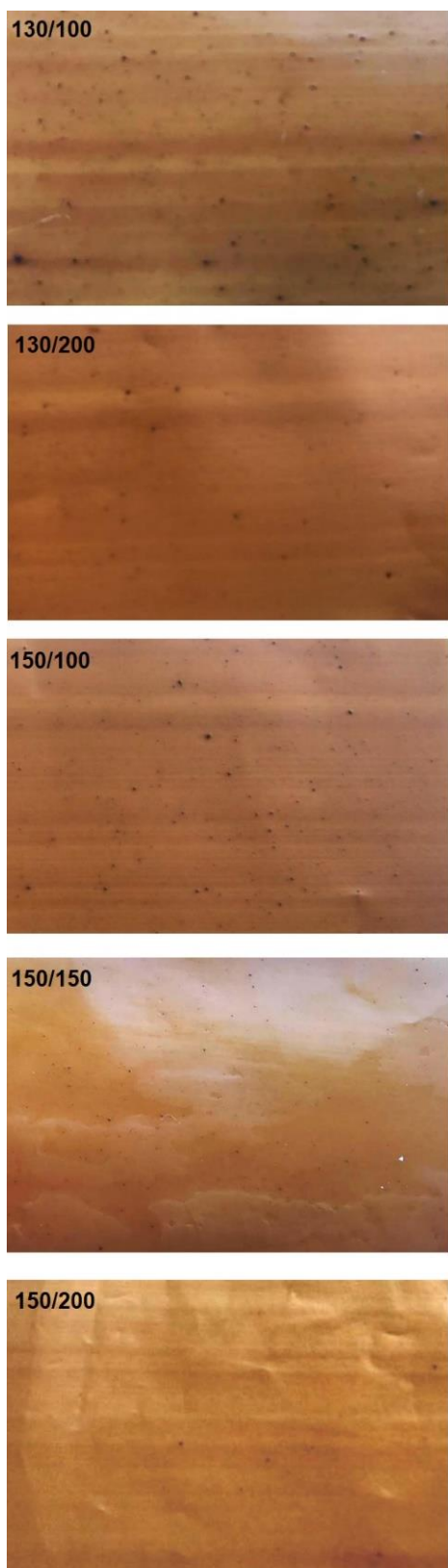
Figura 5.2: Imagens fotográficas dos filmes de PBSA/lignina 95/5, fração mássica nominal, processados em diferentes condições.
