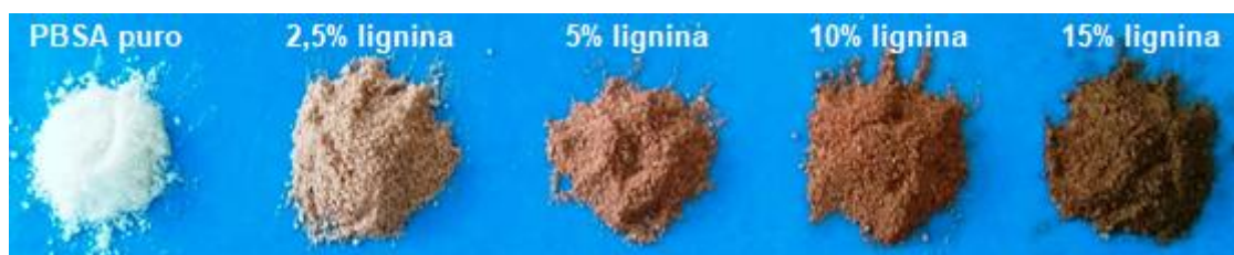
Figura 4.4: Foto das misturas de PBSA pulverizado e lignina após homogeneização por tamboreamento manual.
