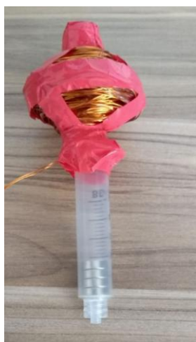
Figura 23: Estrutura do Gerador de Indução Eletromagnética montada.
