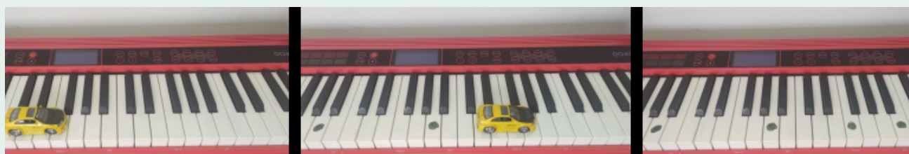
Figura 18: Carrinho em movimento uniformemente variado deixando gotas de óleo em um teclado.
