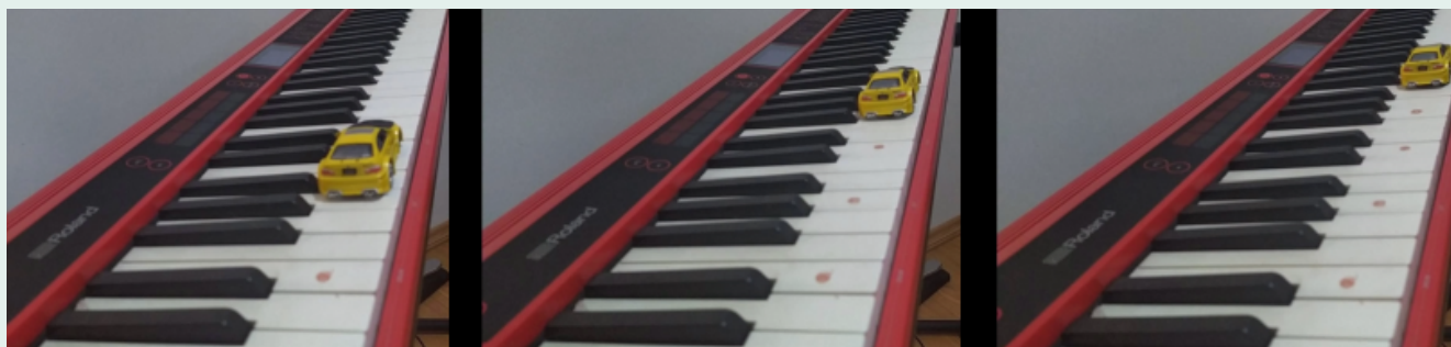
Figura 16: Carrinho em movimento uniforme deixando gotas de óleo em um teclado.
