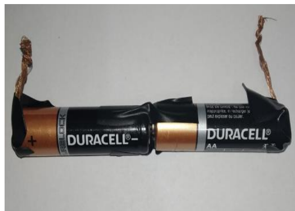
Figura 4.17: Montagem das duas pilhas em série – autor.
