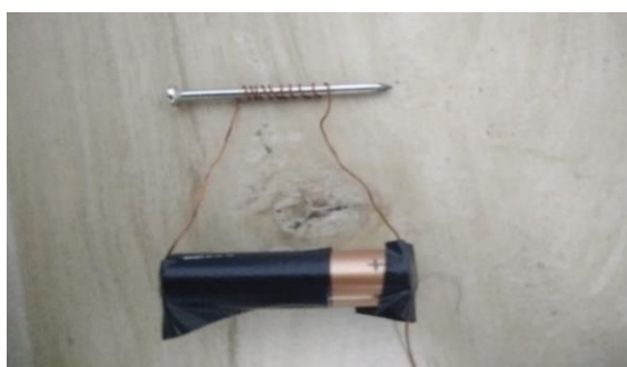
Figura 4.8: Eletroímã com uma pilha e 10 voltas em torno do prego (medida B_1 – 10 voltas).
