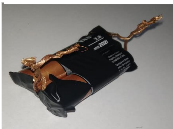
Figura 4.16: Montagem das duas pilhas em paralelo – autor.
