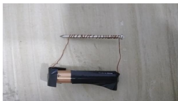
Figura 4.9: Eletroímã com uma pilha e 20 voltas em torno do prego (medida B_1 – 20 voltas).
