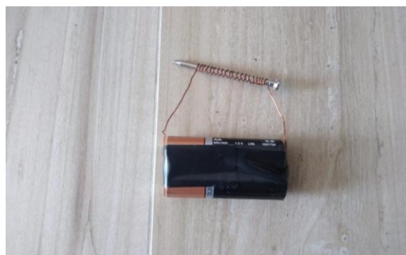
Figura 4.12: Eletroímã com duas pilhas em paralelo e 20 voltas em torno do prego (medida B_{2p} – 20 voltas).
