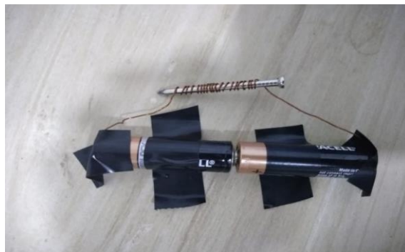
Figura 4.10: Eletroímã com duas pilhas em série e 20 voltas em torno do prego (medida B_{2s} – 20 voltas).
