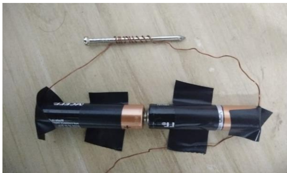
Figura 4.11: Eletroímã com duas pilhas em série e 10 voltas em torno do prego (medida B_{2s} – 10 voltas).
