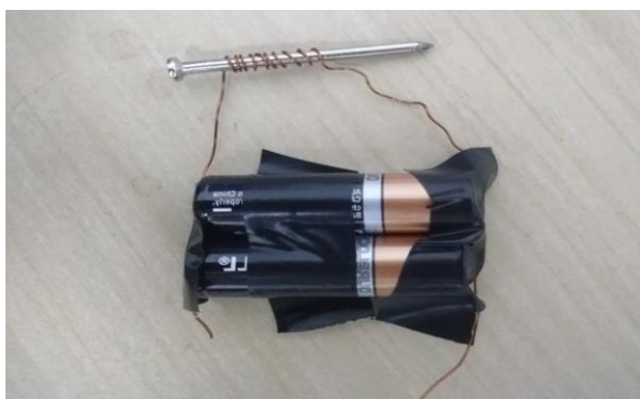
Figura 4.13: Eletroímã com duas pilhas em paralelo e 10 voltas em torno do prego (medida B_{2p} – 10 voltas).
