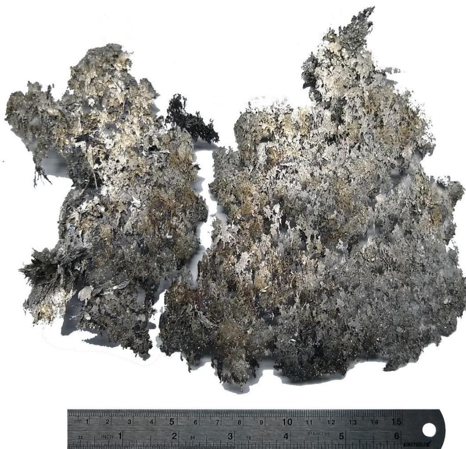
Figura 3.1 – Placas de splats formadas durante o processo de atomização a gás.
