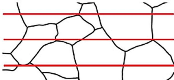
Figura 3.4 – Exemplo de traçado das retas para aplicação do método do intercepto. Fonte: elaborado pelo autor
