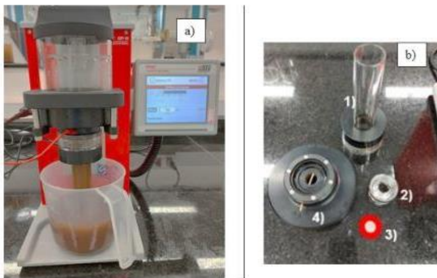
FIGURA 6.3.8-1 -Determinação de potencial Zeta em uma suspensão coloidal de rejeitos a) e apresentação das peças da célula de medição b).
