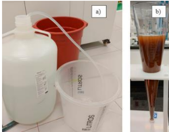
FIGURA 6.3.3-1 – Preparo da suspensão coloidal através do rejeito
