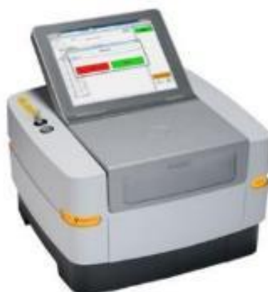
FIGURA 5.4.5-2 - EDXRF Modelo Epsilon 1 com Ampola de raios X com ânodo de prata
