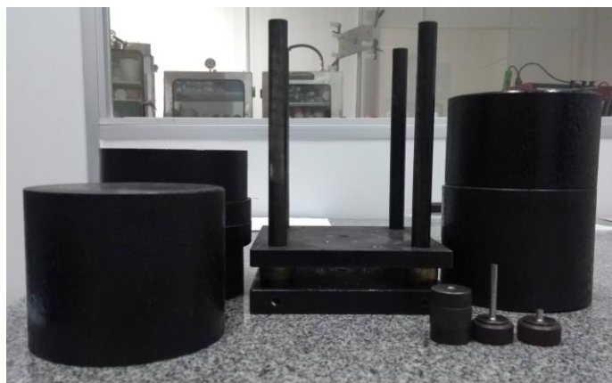
Figura 4.3. Mesa de prensagem, molde e pesos utilizados.
