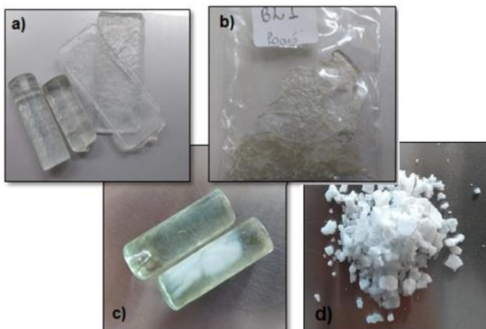
Figura 5.1. Novas composições preparadas a partir do sistema K_2O - CaO - SiO_2 - P_2O_5 . a) BL0 b) BL1 c) BL2 e d) BL3.
