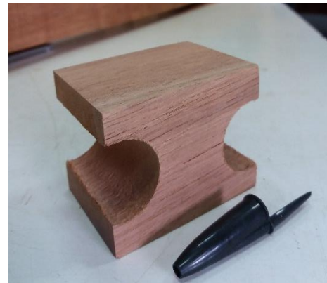
Figura 3.9 - Espécime - Tração Normal - (a) Perspectiva e (b) vista superior.
