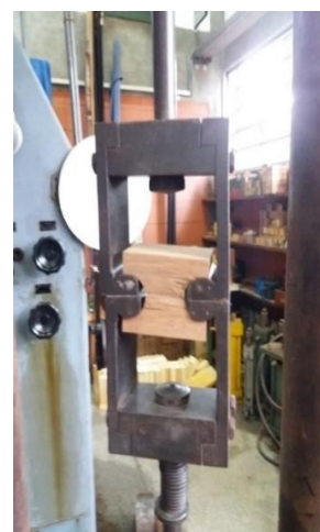
Figura 3.10 - Ensaio - Tração Normal - Espécime (a) antes e (b) depois da ruptura.
