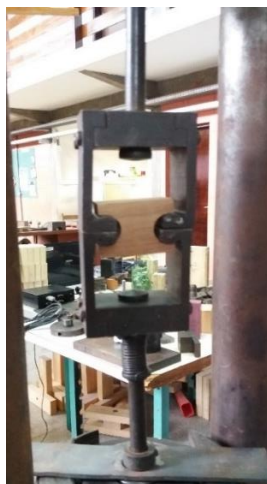
Figura 3.10 - Ensaio - Tração Normal - Espécime (a) antes e (b) depois da ruptura.
