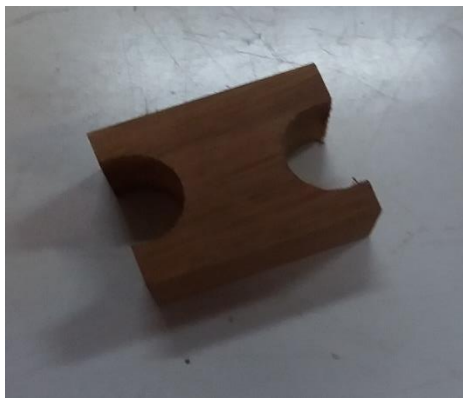
Figura 3.9 - Espécime - Tração Normal - (a) Perspectiva e (b) vista superior.
