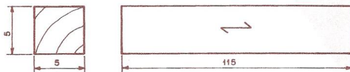
Figura 3.16 – Espécime – Flexão estática (dimensões em cm).
