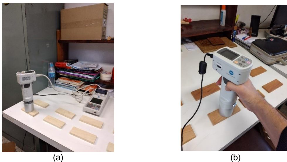
Figura 3.26 – Colorímetro Portátil – (a) Uso com a Impressora e pistola e (b) Uso somente com a pistola.
