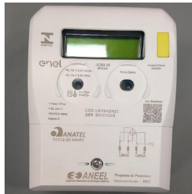
Figura 2 - Medidor de energia inteligente com peças de PC virgem + 10% de fibra de vidro.
