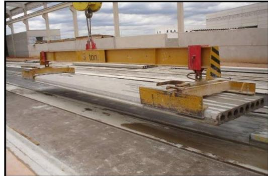
**f) Içamento das lajes através do sistema de garras e balancins**
