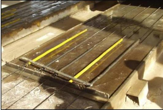
**a) Proteção das cordoalhas para aplicação do desmoldante**
