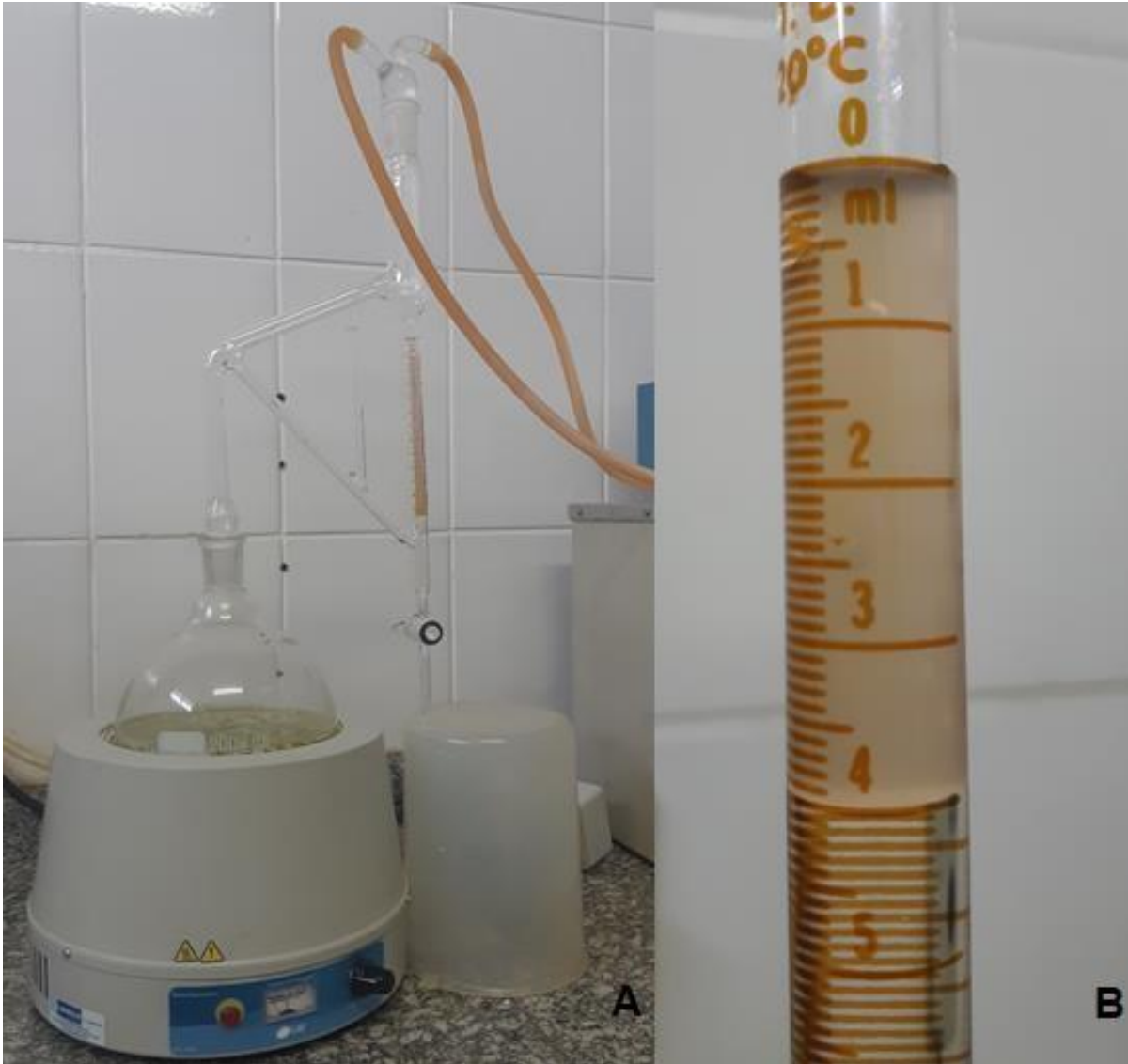
Figura 2. Hidrodestilação do óleo essencial de lima ácida Tahiti. A – Aparelho de Clevenger modificado. B – óleo essencial de lima ácida Tahiti após destilação.
