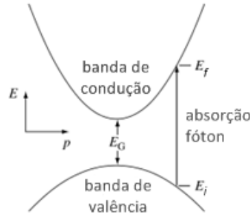
Figura 7: Absorção em semicondutor de gap direto para um fóton incidente de energia h\nu = E_f - E_i > E_G . Fonte: Adaptado da Ref.[1]
