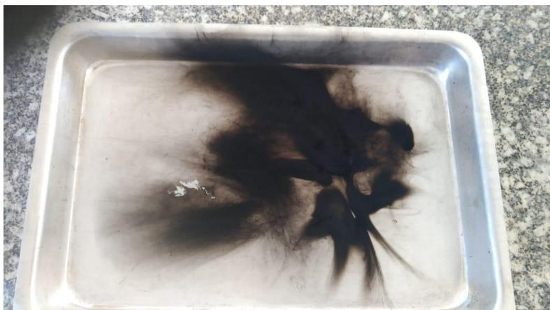
Figura 4: Fuligem coletada em bandeja metálica
