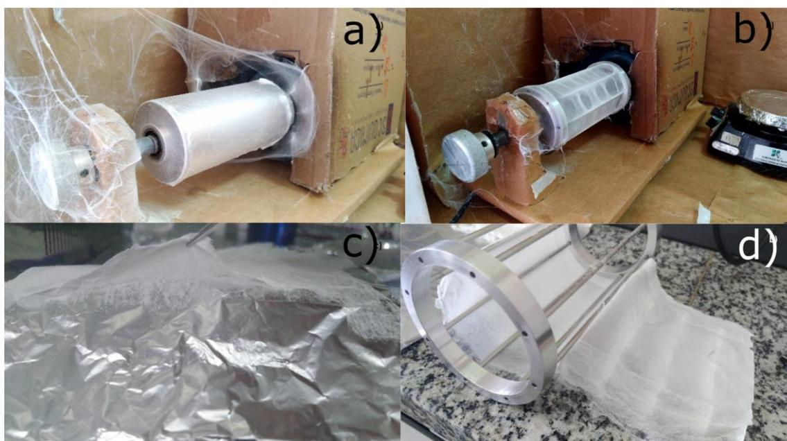
Figura 7: Manta de nanofibras de PA6 produzida por FSS no: (a) coletor de tambor, (b) e coletor vazado de hastes, (c) recuperação da manta no papel alumínio que recobre o coletor de tambor, (d) e coletor vazado de hastes desenvolvido no trabalho, que dispensa uso de papel alumínio e que melhora a recuperação das fibras.
