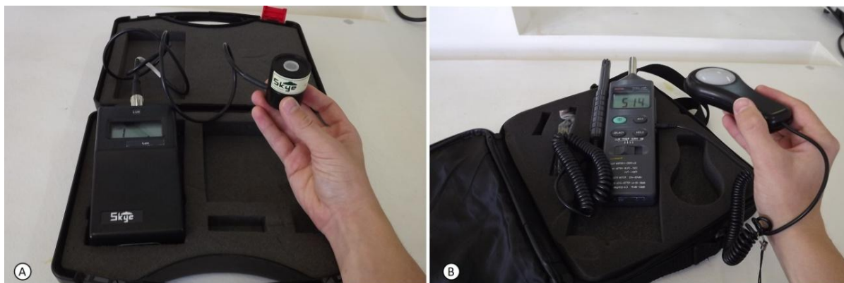
FIGURA 11. Luxímetros utilizados com os seus respectivos sensores demonstrados na mão de um operador. (A) Skye SKL 300, com sensor SKL 310; (B) Medidor ambiental da Instrutherm no modo luxímetro com o respectivo sensor.
